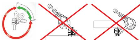
In conformità a quanto prescritto dall'ente tedesco per la sicurezza DGUV utilizzare il dispositivo con la vite fornita in dotazione, in caso di sostituzione della vite Stamperia Carcano SPA declina ogni responsabilità e garanzia.
