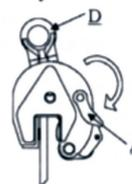
5-Se la morsa non viene più utilizzata, lasciare la leva di blocco (A) in posizione aperta. Questa posizione previene il danneggiamento dei denti di presa.
