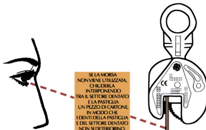
SE LA MORSA NON VIENE UTILIZZATA, CHIUDERLA INTERPONENDO TRA IL SETTORE DENTATO E LA PASTIGLIA UN PEZZO DI CARTONE, IN MODO CHE I DENTI DELLA PASTIGLIA E DEL SETTORE DENTATO NON SI DETERIORINO.
