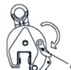
2-Fissare saldamente la morsa sulla lamiera, in modo che il fondo gola (E) della morsa sia posizionato completamente sulla lamiera.
