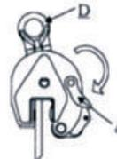
5-Se la morsa non viene più utilizzata, lasciare la leva di blocco (A) in posizione aperta. Questa posizione previene il danneggiamento dei denti di presa.
